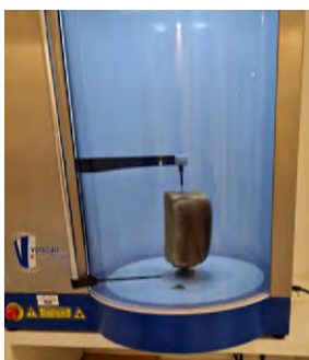
Bild 1: Untersuchungsmethode Volscan (Volumenmessung)
